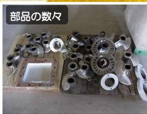
取り外したものを補修するという具合にして使い回しています。その補修は摩耗した部分を肉盛り溶接で元の大きさまで戻した後、旋盤加工で規定の寸法に仕上げるといったものです。
