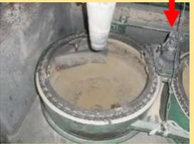
↑この地域で大ヒット！現在も使用中のマキノ製の機械。掻きペラだけをモーターで動かします。円柱は動きません。
