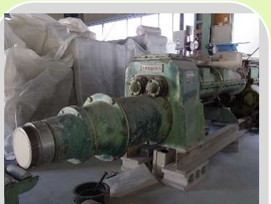
本田鉄工製で最初買った真空土練機。メンテナンスし続け、今でも現役です。
